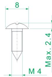
請使用M4圓頭木螺釘，螺絲投直徑 $\phi 8$ 以下，螺絲頭高度不超過2.4mm。
