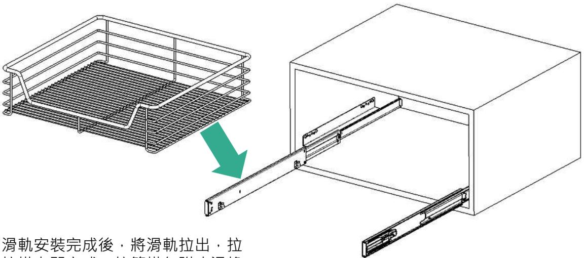
兩側滑軌安裝完成後，將滑軌拉出，拉籃直接掛上即完成。拉籃掛勾附止滑橡皮墊，提供更靜音優質的使用體驗。
